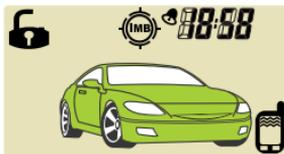
При активному пасивному імобілайзері, Ви можете поставити сигналізацію на охорону як зазвичай, натиснувши КН1 на пульті.
