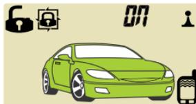
Вы можете **временно отключить** режим метки (но не саму функцию) кратковременным нажатием **КН2+КН3** в любом из режимов сигнализации. Индикация об отключении метки отобразится на экране дисплея на три секунды.
