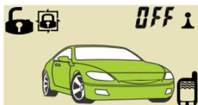
Вы можете поставить сигнализацию на охрану нажав КН1. Сигнализация станет на охрану как обычно. Спустя минуту базовый блок будет периодически проверять нахождение пульта в зоне действия.
