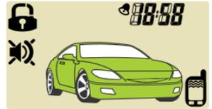
швидко спалахувати протягом 4 секунд (перевіряється справність кінцевих вимикачів і датчика удару і / або додаткового датчика), потім почнуть спалахувати раз в секунду. Блокування двигуна буде активовано, двері закриваються (якщо встановлені замки і виконані відповідні підключення), вікна закриваються (якщо встановлений блок доведення стекол і склопідйомники), датчик удару і / або додатковий датчик будуть взяті під охорону через 30 секунд.
