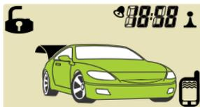
Если, при стоящей на охране сигнализации, багажник не будет закрыт в течение минуты, сирена выдаст пять коротких сигналов и пульт пейджер в течение примерно 10 секунд будет информировать мелодичным сигналом о не закрытом багажнике. Затем концевик багажника будет исключен из зоны охраны, а временно отключенный датчик удара, будет снова включен в охраняемую зону.
