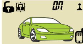
Ви можете **тимчасово відключити** мітку (але не саму функцію) короткочасним натисненням КН2 + КН3 в будь-якому з режимів сигналізації. Індикація про відключення мітки відобразиться на екрані дисплея на три секунди.
