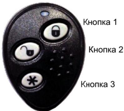
Однонаправленный пульт представляет собой миниатюрное приемо-передающее устройство с питанием от 3 вольтовой батарейки CR-2032. На пульте расположены три кнопки управления. Их назначение и функции такие же как и в двунаправленном пульте. Нажатие и отпускание любой из кнопок пульта подтверждается определенным цветом светодиода. Сформированная команда индицируется зеленым свечением светодиода, передается на базовый блок сигнализации и меняется при каждом новом нажатии и отпускании кнопки пульта.
