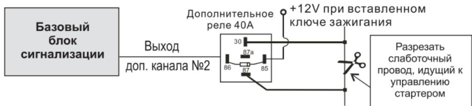
Во втором режиме этот канал может использоваться для поддержки зажигания в состоянии ВКЛЮЧЕНО (с помощью дополнительного реле) при активированном режиме ОХРАНА С ЗАВЕДЕНИМ ДВИГАТЕЛЕМ.
